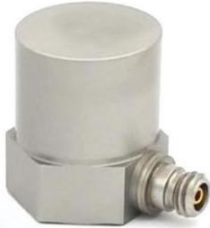
G59AS系列产品是一款可同步测量振动和冲击的低噪声IEPE单轴加速度传感器，此加速度传感器的内部电路（TEDS功能可选）是在IEPE系统的两线制上同时提供恒流源激励和传输低阻抗电压输出信号，信号地与外壳相连，绝缘安装螺丝及安装座可选；同时信号放大电路设计考虑了极性反向保护。外壳采用激光焊接工艺以保证产品的密封性；输出连接头采用侧出微型1032的玻璃绝缘连接器以满足不同环境下使用时输出的稳定性。G59AS系列加速度传感器除了粘合剂安装还提供了1032的螺孔以便牢固安装；G59AS系列加速度传感器具有宽频带响应特性，广泛应用于轻量结构产品做振动、冲击测试。另外，鑫源宇通还提供与微型10-32接头配套的光纤，型号1032可选，具体参见配件表格。
