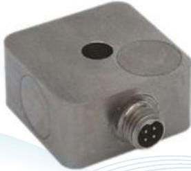
G56AT系列产品是一款为测试测量应用设计的IEPE三轴加速度传感器，利用压电陶瓷作为敏感元件，具有宽频带响应特性。此IEPE加速度传感器通过结合优质的晶体和低噪声微电子元件，与其他敏感元件相比在工作温度范围内获得了超低温度灵敏度变化/响应；剪切模式技术同样保证了卓越的基座灵敏度应变误差。G56AT加速度传感器采用钛合金为产品外壳，通过激光焊接与轻量化的4针连接器密封（可选一体密封线缆输出）以保证低重量，宽频带情况下的应用。出色的幅值和相位频率响应，使得此加速度传感器非常适合结构模态测试、部件测试、跌落测试和一般实验室振动测试的用户使用。传感器的通孔安装方式使得测试工程师或技术员可以很方便的同步测量三个相互垂直轴向的加速度，且测试数据可靠，长期稳定。
