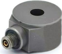
G48AS是一款可同时测量振动和冲击的IEPE单轴加速度传感器，其特点是采用环形剪切模式的陶瓷晶体为敏感元件，具有长时间保持输出稳定的特性。此加速度传感器的内部电路是在IEPE系统的两线制上同时提供恒流源激励和传输低阻抗电压输出信号，信号地与外壳隔离，内部屏蔽；同时信号放大电路设计考虑了极性反向保护。外壳采用激光焊接工艺以保证产品的密封性；输出接头采用微型10-32的玻璃绝缘连接器以满足不同环境下使用时输出的稳定性。G48AS系列加速度传感器除了粘合剂安装还提供了 $\phi 5.1$ 通孔进行螺丝安装；传感器出线方向任意可调。G48AS系列加速度传感器具有超高的频带响应，广泛应用于旋转设备的振动、冲击测试；特别适合应用于电磁环境比较复杂的发动机或变速箱健康监测系统(HUMS)。另外，鑫源宇通还提供与微型1032接头配套的输出线缆，具体参见配件表格。
